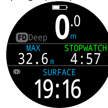
Par défaut, le chronomètre est affiché dans les modes Gauge (Profondimètre) et Freedive (Apnée).
