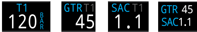
Pression bloc Temps de gaz restant Consommation d'air en surface Combiné miniature
